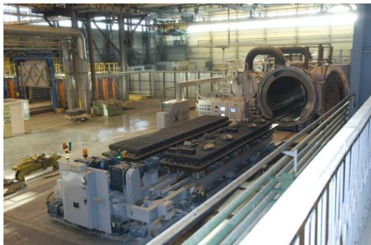
Вакуумная печь для термообработки титановых деталей Ø1800 мм x 5000 мм
