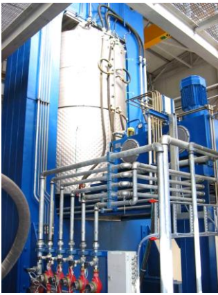
Газостат \varnothing 700 \times 1500 мм, обеспечивающий давление до 2500 bar, температуру до 1400 C
