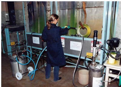
Аттестованное NADCAP оборудование для контроля титановых деталей методом люминесцентного контроля
