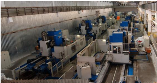
Участок механической обработки. Парк оборудования для механической обработки имеет тяжелые, средние и легкие обрабатывающие центры известных фирм: MAG Cincinnati, Tacchi, TOS Kuřim, WMW.
