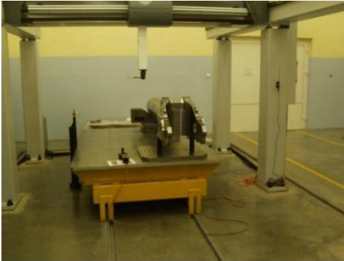
Геометрический контроль с использованием координатно-измерительных машин и портативного оборудования производства компании FARO позволяет получать высокоточные 3D измерения деталей в рамках программы контроля качества.
